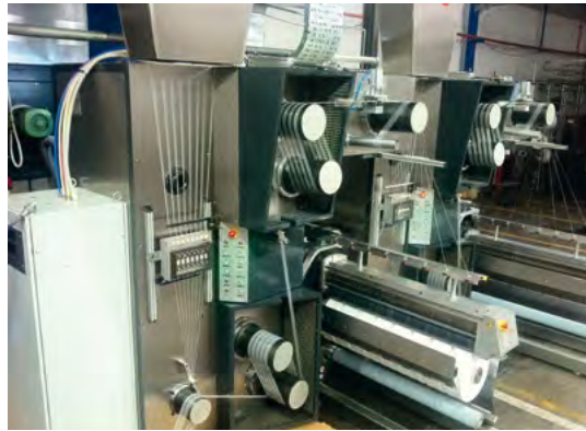
İplik üretim makinesinde sündürülerek dayanıklılığı ayarlanan iplikler
